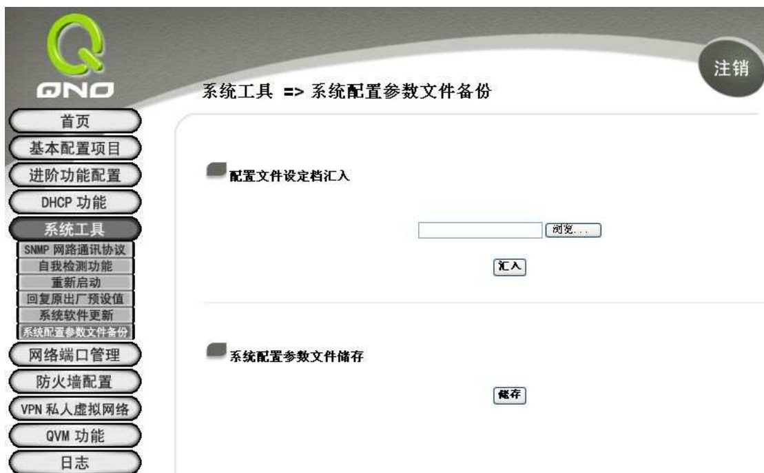
图三：侠诺路由器的“配置参数备份/恢复”内有“系统配置参数文件储存”及“配置文件设定文件汇入”功能，可用于备份所有配置参数，方便又可增加安全度。
